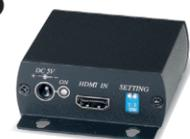
Extender CAT5e HDMI (Trasmittitore + Ricevitore) utilizza un solo cavo CAT5e / 6, campo di trasmissione fino a 40 metri con risoluzione 1080p. E' dotato di connettori HDMI e supporta anche apparecchiature DVI permettendone l'uso con un adattatore HDMI-DVI (non incluso), con alimentatori in dotazione. TX (67.0x91.0x27.0mm), RX (67.0x120.0x27.0mm)
