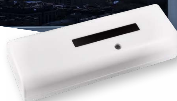
AX-TE03sw Sensore a tenda per la protezione di varchi come porte, finestre, tapparelle, zanzariere. Sensore NON PIR (cioè non a infrarossi passivi) che rileva su un centinaio di punti la presenza statica della radiazione termica del corpo umano, associandola al suo spostamento spaziale con drastica riduzione di allarmi impropri.
